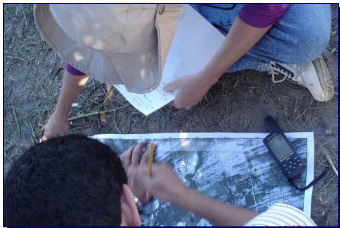
Foto 1: Exemplo do uso do GPS para os procedimentos de georreferenciamento dos pontos de campo.
